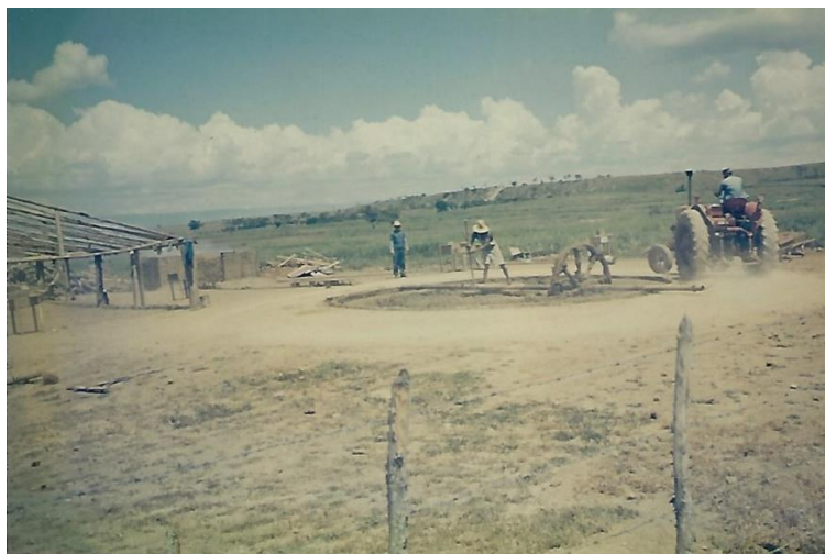
Mechanizované drcení siltovce, cihelna Guantanamo, provincie Oriente.
